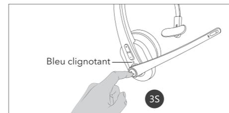
2) Le dongle se connectera automatiquement à l'oreillette. Une fois connecté, l'indicateur du dongle restera bleu fixe. L'indicateur de l'oreillette clignotera en bleu.
