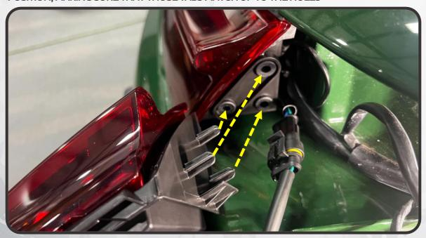
23. FULLY PRESS THE TAIL LIGHT INTO POSITION AND SECURE IT USING THE PHILLIPS HEAD SCREW OUT THE FORWARD CORNER OF THE LIGHT.
