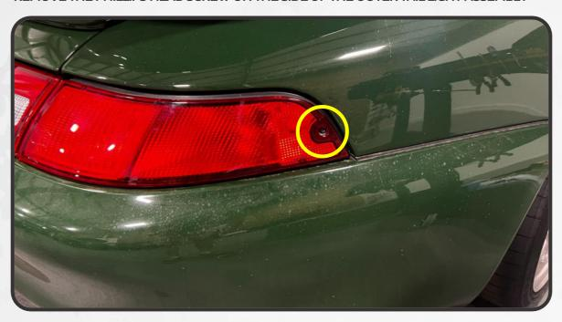
2. PULL THE TAIL LIGHT ASSEMBLY OUT AND AWAY FROM THE VEHICLE
