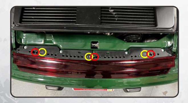
21. CONNECT THE OUTER TAIL LIGHT TO THE TWO OPEN VEHICLE CONNECTORS (THE SIDE MARKER SHOULD BE BLOCKED OFF) AND THE 3-PIN CONNECTOR ON THE CENTER TAIL LIGHT
