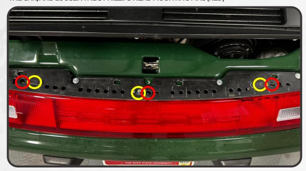
9. SLIDE THE CENTER TAIL LIGHT BACK AWAY FROM THE VEHICLE TO REMOVE IT
