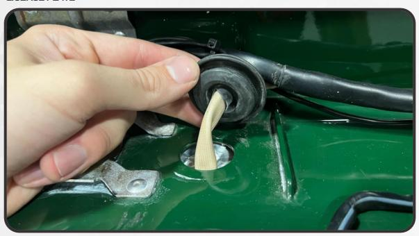
14. ROUTE THE BOOST BAR WIRING OVER FROM THE BAR TO THE OPENING IN THE BUMPER THAT WAS BEHIND THE BUMPERETTE
