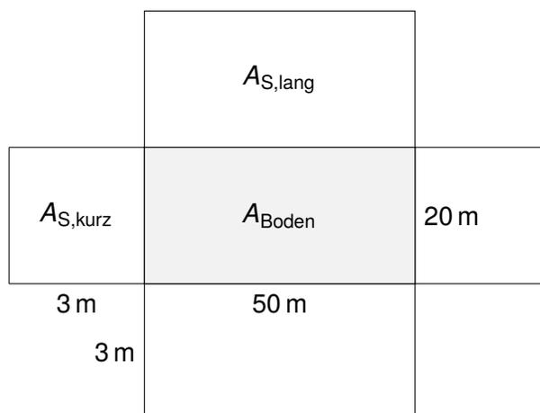
Der Boden des Schwimmbads wird durch die graue Fläche dargestellt. Zusätzlich zu dieser Fläche werden vier Seitenflächen gefliest. Daraus folgt:
