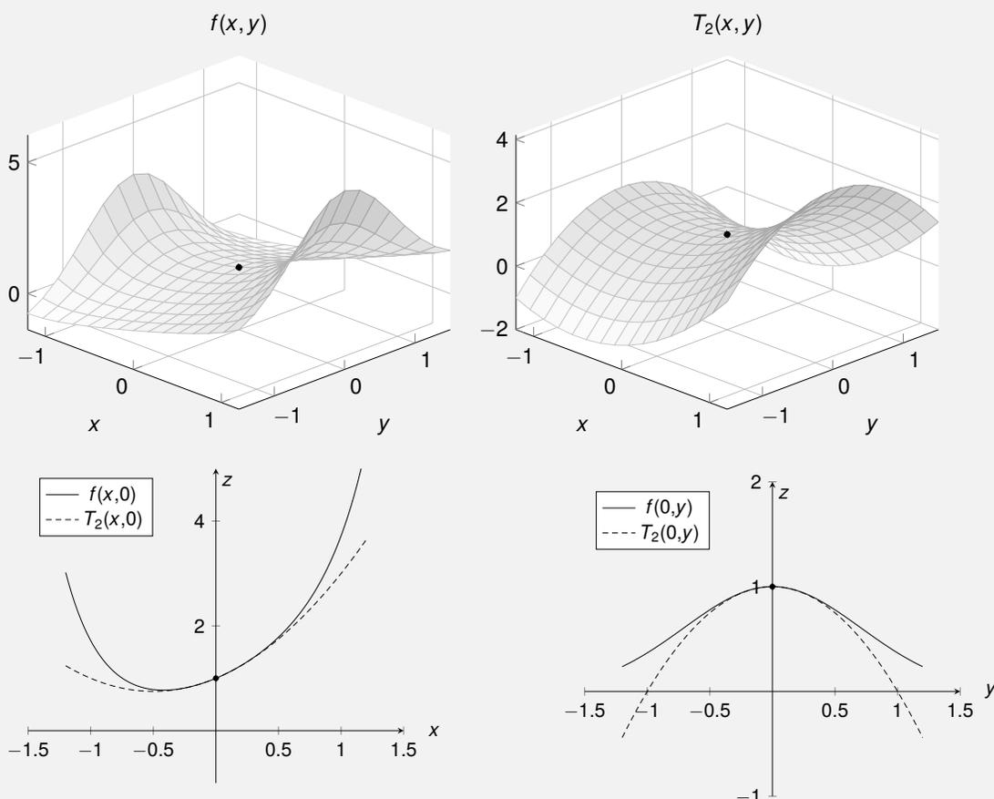
Wie wir sehen, schmiegt sich der Graph von  $T_2$  dem Graphen von  $f$  an der Stelle  $(0, 0)$  sehr gut an. Je weiter wir uns von  $(0, 0)$  in der  $x$ - $y$ -Ebene entfernen, desto größer wird der Fehler zwischen  $T_2$  und  $f$ .
