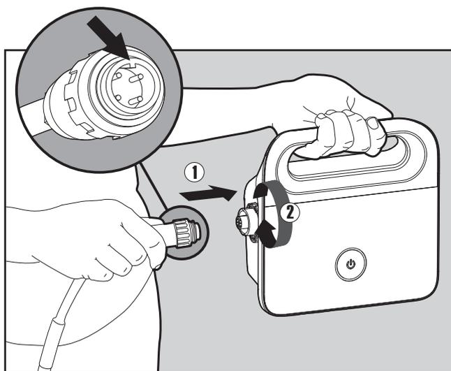
**5.1.3** Attaccare il cavo blu all'alimentatore inserendolo con l'incavo sul connettore (1) allineato con la scanalatura nella presa sull'alimentatore. Girare in senso orario (2).
