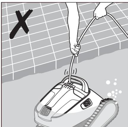
5.4.2 Usando il cavo blu, portare il robot sul bordo della piscina.
