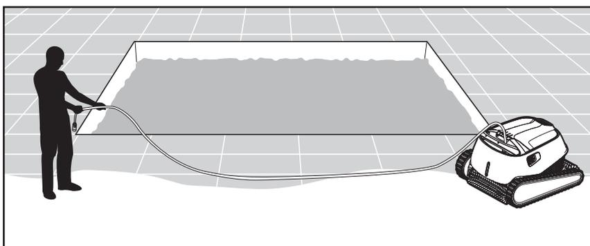
**5.1.1** Posizionare l'alimentatore in modo che sia circa al centro del lato lungo della piscina a 3,5 m / 12 ft di distanza.
