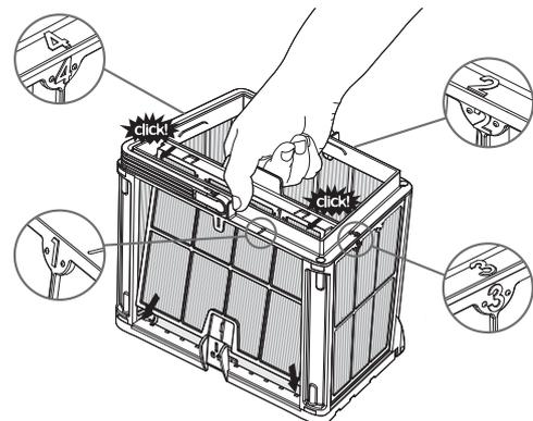
**8.2.5** Monte los paneles de filtración con el siguiente orden: 4 > 3 > 2 > 1.
