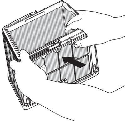
**8.2.2** Desmonte los paneles usando sus pulgares para presionar en el panel 1.
