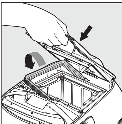
**8.2.6** Inserte la canasta de filtración limpia y cierre la tapa del filtro.
