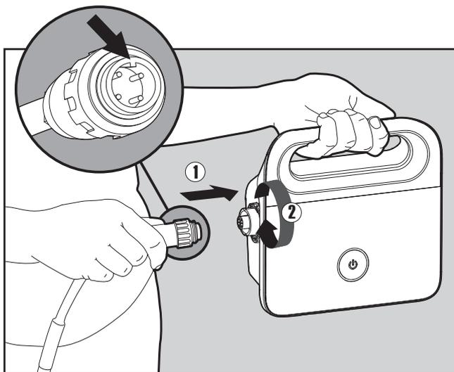
**5.1.3** Conecte el cable azul a la fuente de alimentación, insertándolo con la muesca en el conector (1) alineada con la ranura en el conector de la fuente de alimentación. Gírelo en sentido horario (2).
