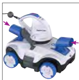
Boquilhas ajustáveis 1 frontal e 1 traseira
