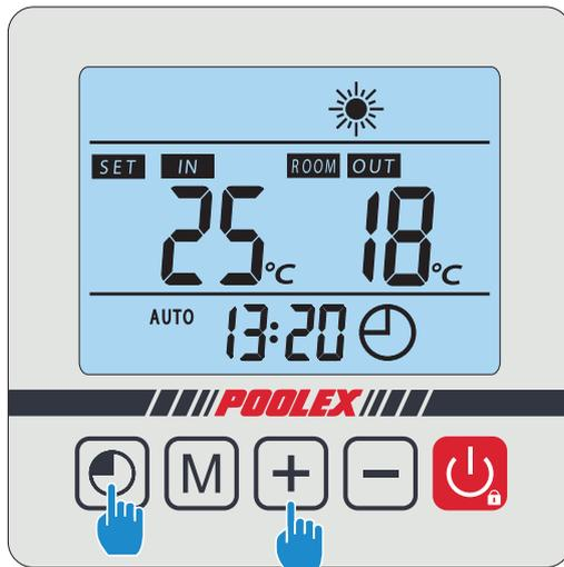
Appuyez sur + simultanément pendant 5s, le voyant **SET** clignote rapidement, le boîtier de commande est prêt à être appairé.
