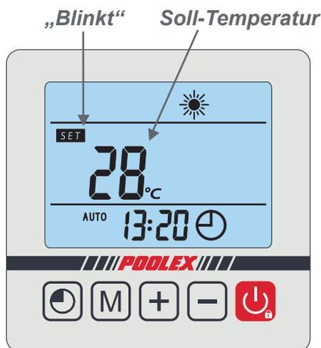
Sobald das Symbol **SET** nicht mehr blinkt, ist die angeforderte Temperatur gespeichert, und es wird erneut die aktuelle Wassertemperatur angezeigt (in unserem Beispiel 25 °C).
