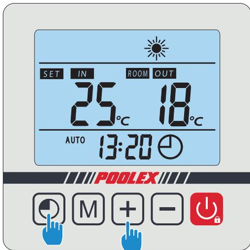
Drücken Sie **M** + **+** gleichzeitig für 3s, **SET** blinkt schnell, die Steuerbox ist bereit zum Pairing.
