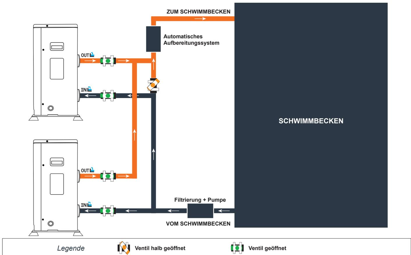
Der der Wärmepumpe vorgeschaltete Filter muss regelmäßig gereinigt werden, damit das zirkulierende Wasser sauber ist und etwaige Funktionsprobleme aufgrund einer Verschmutzung oder Verstopfung des Filters vermieden werden.
