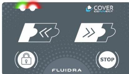
LED vermelho intermitente durante a abertura/fecho: bateria fraca, deverá ser substituída.
