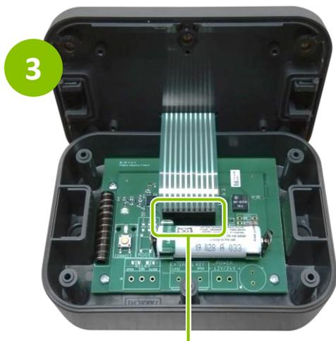
2 Atenção ao cabo fita do teclado quando abrir a caixa e substituir a bateria.
