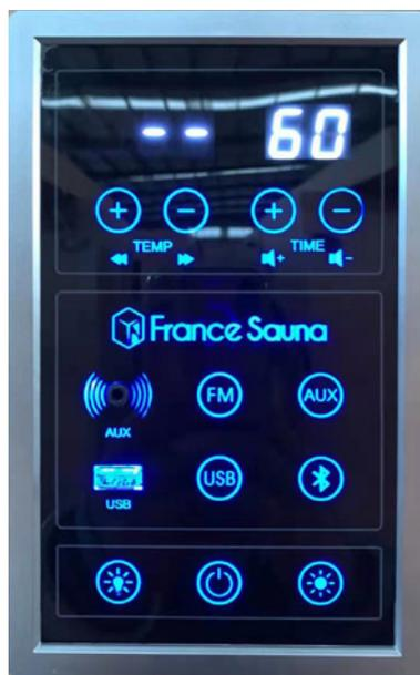
Connectez l'unité d'alimentation à la prise murale, l'indicateur LED clignotera sur l'afficheur. Il est maintenant possible d'allumer les émetteurs infrarouges, la lumière et la musique.
