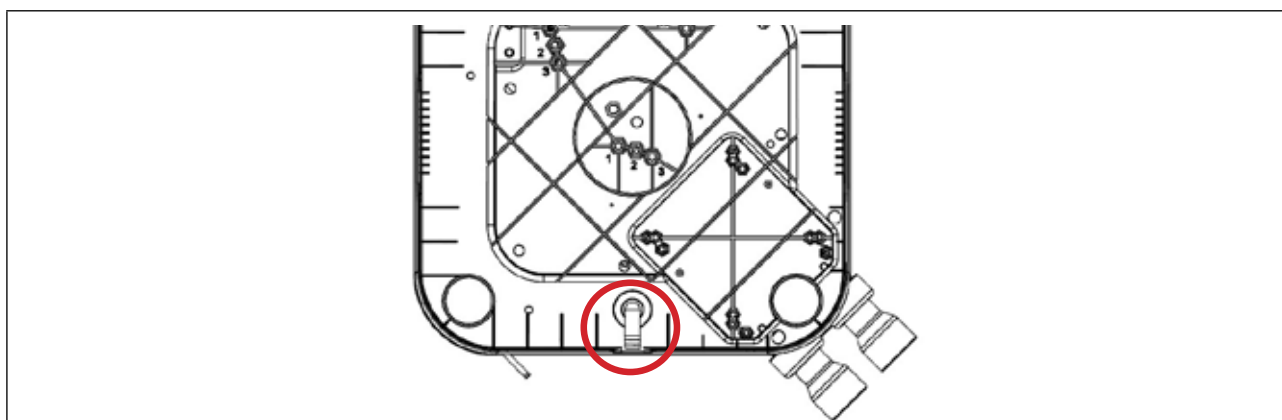
Orientation de l'évacuation des condensats (vue du dessous de l'appareil)
