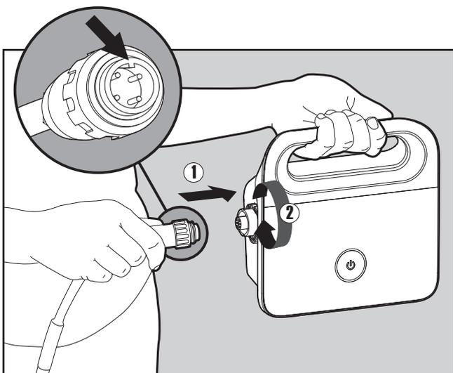
**5.1.3** Das Schwimmkabel mit dem Stromversorgungsgerät verbinden, indem Sie es so einführen, dass die Nut am Stecker (1) auf die Kerbe im Anschluss am Stromversorgungsgerät ausgerichtet ist, und es im Uhrzeigersinn drehen (2).
