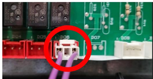
D06 a 3 sorties - 1 correspond au neutre et 3 correspond à la phase. C'est une sortie 220 V AC.
