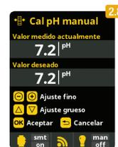
**2.8** Sin sacar la sonda del agua, fije con las teclas **más/menos** el ajuste de la lectura para que coincida con su valor de referencia (fotómetro u otro medidor).
