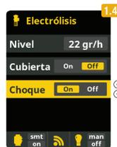
**1.4 Choque:** Filtración continua durante 24 horas a intensidad máxima. Retorno automático al modo de filtración programado.
