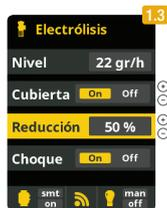
**1.3 Cubierta:** Conexión de la cubierta automática. **Reducción** a porcentaje de producción de cloro cuando se cierra la cubierta.
