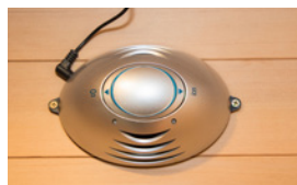
Purificación de la cabina mediante ionizador
