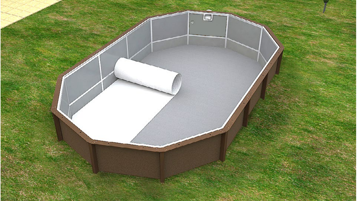
Emplacement du feutre Géotextil
