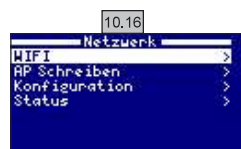
10.16 WLAN: Wählen Sie "WIFI", um die verfügbaren Netze am Modul anzuzeigen. Die Suche läuft automatisch ab.
