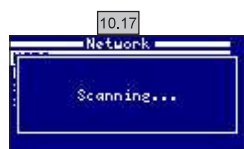
10.17 Выберите желаемую сеть. Введите пароль на всплывающей клавиатуре. Используйте клавиши «вверх»/«вниз» для перемещения вверх и вниз, а также клавиши «плюс»/«минус» для перемещения влево и вправо. Чтобы выбрать букву, нажмите на OK.
