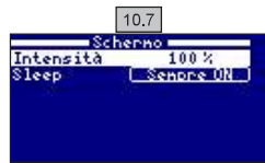
10.7 Impostare l'intensità di illuminazione del display (0-100%) e programmare la durata di accensione/spengimento del display.
