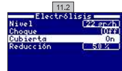
11.2 Reducción a porcentaje de producción de cloro cuando se cierra la cubierta. Con la cubierta cerrada no es necesario que el equipo funcione al 100%, regule con este parámetro la cantidad óptima de generación de cloro.
