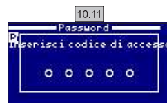
10.11 Password: Permette di proteggere l'accesso al menù utente attivando una password. Per inserire la password premere una combinazione di 5 tasti e il sistema la memorizzerà. Se la password viene dimenticata, è prevista una "password master". Chiedere all'installatore/fornitore.
