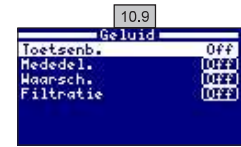
10.9 Geluid: Programmering van het systeem dat geluiden voortbrengt voor de volgende functies: Toetsenb. (toetsen), Mededel. (urgente berichten), Waarschw. (alarm), Filtratie (start filtratie).
