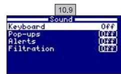
10.9 Звук: программирование системы подачи звуковых сигналов для следующих функций: Клавиатура (клавиши), Всплывающие окна (срочные сообщения), Аварийные сигналы (сбои в работе), Фильтрация (начало фильтрации).
