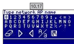
10.17 Selecionar a rede desejada. Inserir a senha no teclado visualizado. Utilizar as teclas de seta para cima/para baixo para subir ou descer no teclado e as teclas mais/menos para se deslocar para a esquerda ou para a direita. Para selecionar uma letra, premir OK.
