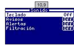
10.9 Sonido: Programación del sistema para emitir sonidos para las funciones: Teclado (pulsación de tecla); Avisos (mensaje emergente); Alertas (alarma de funcionamiento); Filtración (comienzo de la filtración).
