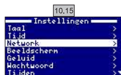
10.15 WiFi Network: Nadat de WiFi-module is aangesloten, start u uw apparaat opnieuw. De optie Network verschijnt dan in het menu Instellingen.
