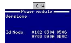
10.14 Informazioni di sistema: Informazioni sulla versione di software disponibile del display TFT e del modulo di alimentazione. Visualizza anche il nodo ID necessario per la configurazione del collegamento Wi-Fi del sistema.
