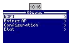
10.16 WiFi : Sélectionnez WiFi pour afficher les réseaux disponibles accessibles au module. La recherche s'effectue automatiquement.
