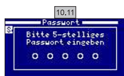
10.11 Passwort: Zugangsbeschränkung zum Benutzermenü durch Vergabe eines Passworts. Zur Eingabe Ihres Passworts wählen Sie eine Kombination aus 5 Tasten. Diese Kombination wird im System gespeichert. Wenn Sie Ihr Passwort vergessen, gibt es ein „Master-Passwort“. Kontaktieren Sie Ihren Hersteller/Händler.
