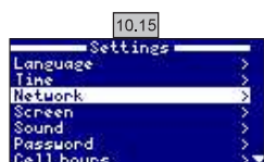
10.15 Сеть Wi-Fi: после подключения модуля Wi-Fi перезапустите прибор. В меню «Регулировки» появится опция «Сеть».
