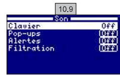
10.9 Son : Programmation du système d'émission de sons pour les fonctions : Clavier (touches), Pop-ups (messages urgents), Alertes (alarme de fonctionnement), Filtration (début de la filtration).
