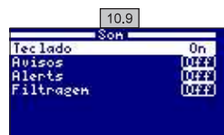
10.9 Som: Programar o sistema de emissão de sons correspondentes às funções: Teclado (teclas); Avisos (mensagem visualizada); Alarmes (alarmes de funcionamento); Filtragem (início da filtragem).
