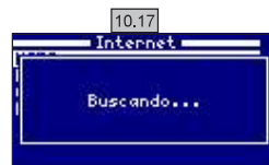
10.17 Seleccione la red deseada e introduzca a continuación el password de la misma en teclado emergente. Desplácese hacia arriba y abajo con las teclas subir/bajar y de izquierda a derecha con las teclas más/menos. Para seleccionar una letra presione OK.
