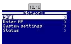
10.16 Wi-Fi: выберите Wi-Fi для отображения доступных сетей для модуля. Поиск осуществляется автоматически.
