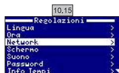
10.15 Network: Dopo aver collegato il modulo Wi-Fi, riavviare l'unità. Nel menù "Regolazioni" comparirà l'opzione "Network".
