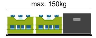
Belade deine heckBOXX flächig maximal mit 150kg.
