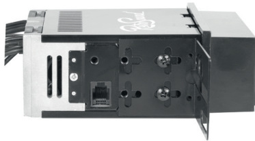
Abbildung 1 - Befestigung der Montagehalterungen
