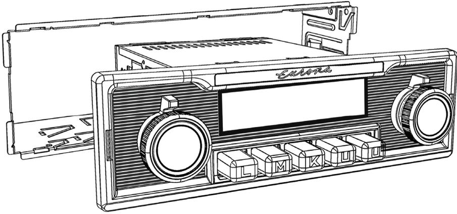
Bevor Sie das komplettierte Radio in den DIN-Schacht einsetzen, schalten Sie das Gerät ein um das Radio zu testen und zu sehen, ob alle Verbindungen korrekt sind. Schieben Sie nach dem Testen das Radio in den DIN-Rahmen, bis es einrastet.
