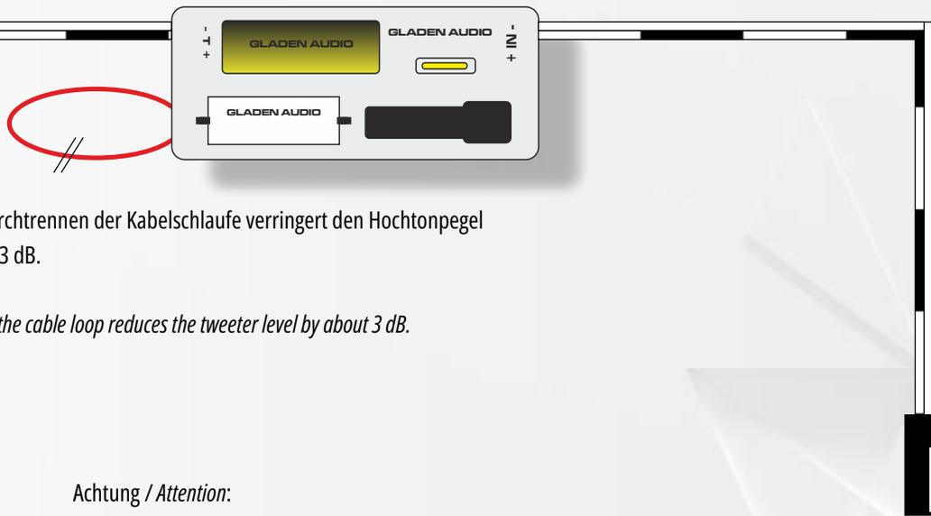
Das Durchtrennen der Kabelschleife verringert den Hochtonpegel um ca. 3 dB.
