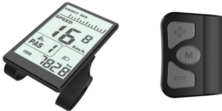
Der Hauptkörper der Taste besteht aus PC-Material und der Tastenteil aus weichem Silikon in schwarzer Farbe. NOKEE Die Taste hat drei Tasten. Dazu gehören die "M"-Taste für den Einschaltmodus, die "+"-Taste für den Plus-Modus und die "-"-Taste für den Minus-Modus. In der folgenden Anleitung wird die Taste "M" durch den Text [MODE], die Taste "+" durch den Text [UP] und die Taste "-" durch den Text [DOWN] ersetzt.
