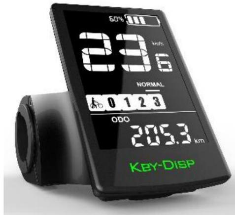
Das Instrument KD716-V entspricht den K5-Tasten und hat 5 Tasten: ON/OFF, i-Taste, Plus-Taste, Scheinwerfer-Taste und Minus/Boost-Taste; in den folgenden Beschreibungen wird die ON/OFF-Taste durch das Wort ON/OFF ersetzt, die i-Taste durch das Wort i, die Plus-Taste durch + und die Minus/Boost-Tasten durch "-".
