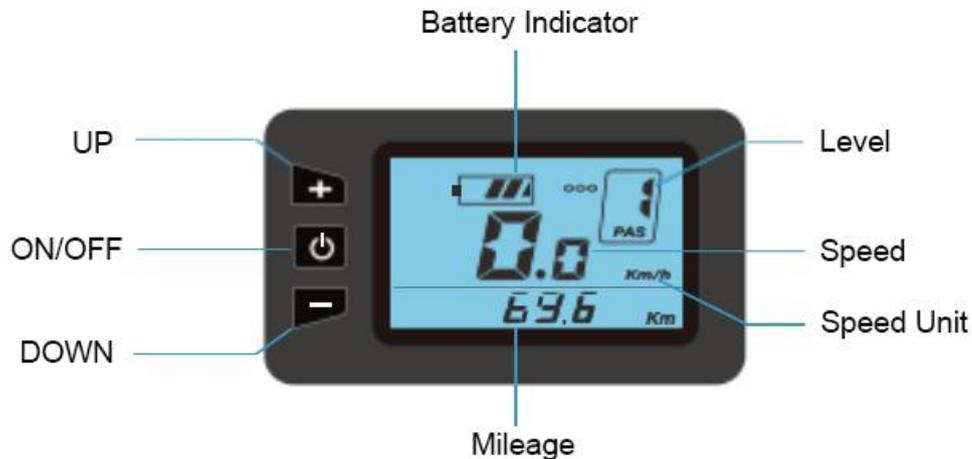
Auf dem Instrument befinden sich drei Tasten: Ein/Aus, Plus/Scheinwerfer und Minus/Boost; in den folgenden Anweisungen wird die Ein/Aus-Taste durch das Wort "ON/OFF", die "+"-Taste durch das Wort "UP" und die "-"-Taste durch das Wort "DOWN" ersetzt.
