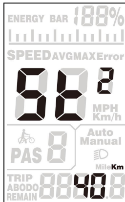
Schnittstelle zum Einstellen der Geschwindigkeitsbegrenzung
