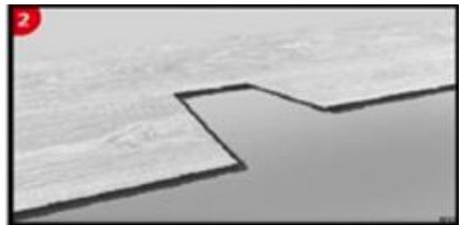
ÉTAPE 3 : Glissez la planche du côté long jusqu'à ce que la languette du côté court effleure à peine la rainure du côté court de la planche précédente.
