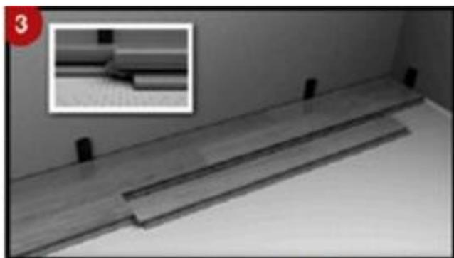
ÉTAPE 4 : Soulevez les deux planches à un angle d'environ 30°. Assurez-vous de ne déclipeter le système de verrouillage du côté court de la planche.
