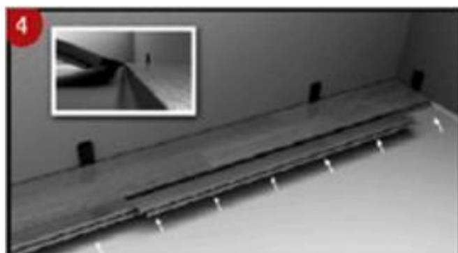
ÉTAPE 5 : En gardant le côté court verrouillé, faites glisser les planches en parallèle avec le sol jusqu'à que la languette du côté long s'insère dans la rainure.
