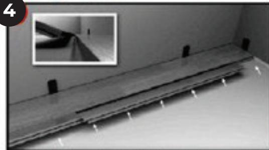
ÉTAPE 4 : Soulevez les deux Plancher à un angle d'environ 30 degrés. Assurez-vous de ne déclipeter le système de verrouillage du côté court du carreau.
