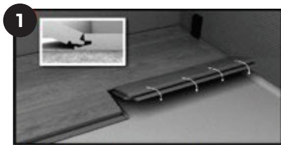
ÉTAPE 1 : Verrouillez en place le côté long du carreau en insérant la languette dans la rainure en position angulaire, puis en abaissant la planche.
