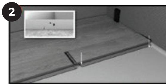
ÉTAPE 2 : Glissez le carreau vers l'extrémité du carreau précédent jusqu'à ce que la languette effleure à peine la rainure.
