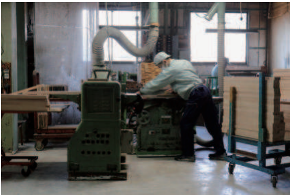
手押しカンナによる基準面の作成。 次工程での作業を円滑に行うために丁寧にいきます。
