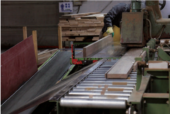
リップソーによる木材の幅決め。 自然の木が相手だからこそ、1本1本見極めて、 最も効率のよい材幅を確保します。
