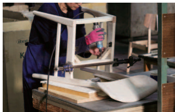
椅子は組み立て後に「根子」を付けて補強します。
