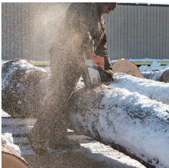
直径75cm～1mにもなる大木をチェーンソーでカットし、順番に製材されていきます。
