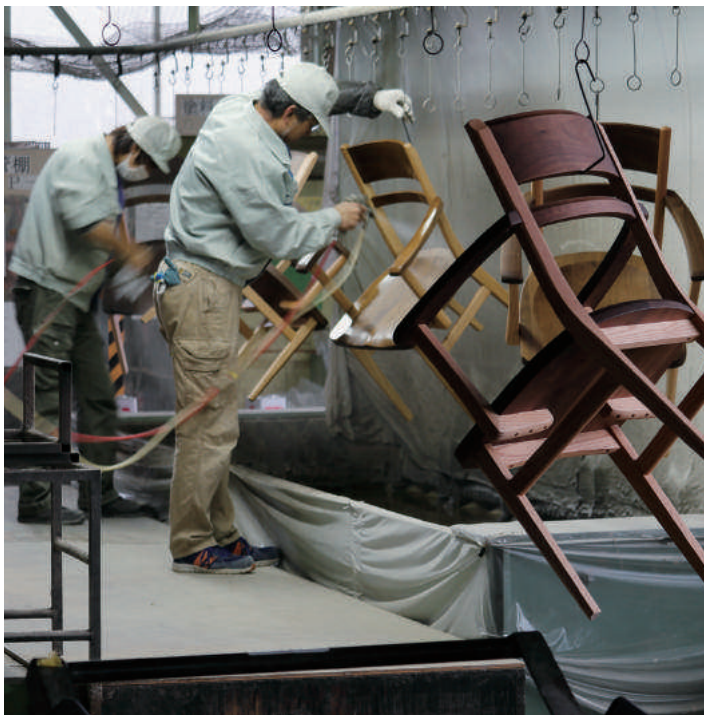
椅子はチェーンコンベアに吊り下げて、塗装と乾燥を順番に繰り返していきます。
