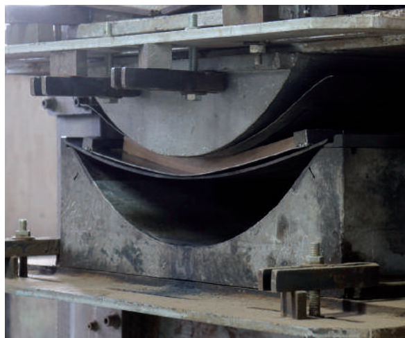
大型のプレスで、すばやく曲げて、熱を加えて乾燥させていきます。
