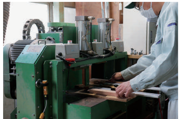
ホゾ加工は高い精度が求められるため、専用機を使い効率と精度を両立させています。
