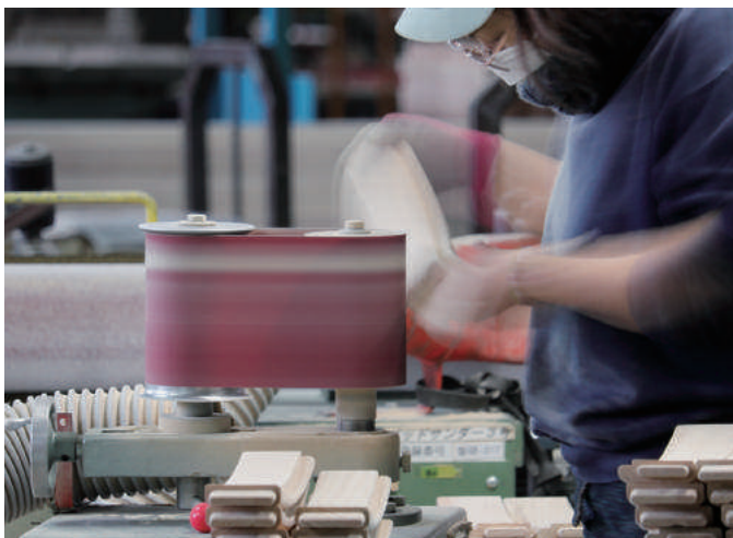
部品数が多く、生産量も多い椅子の部材はリズムよく研磨をしています。
