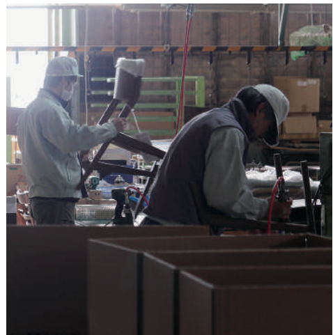
仕上がった椅子は座面の取り付け及び外観検査を経て、梱包されていきます。
