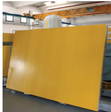
COD. A2116 HYDRAULIC TILTING TABLE BANCO RIBALTABILE IDRAULICO 2000 x 3500 mm
