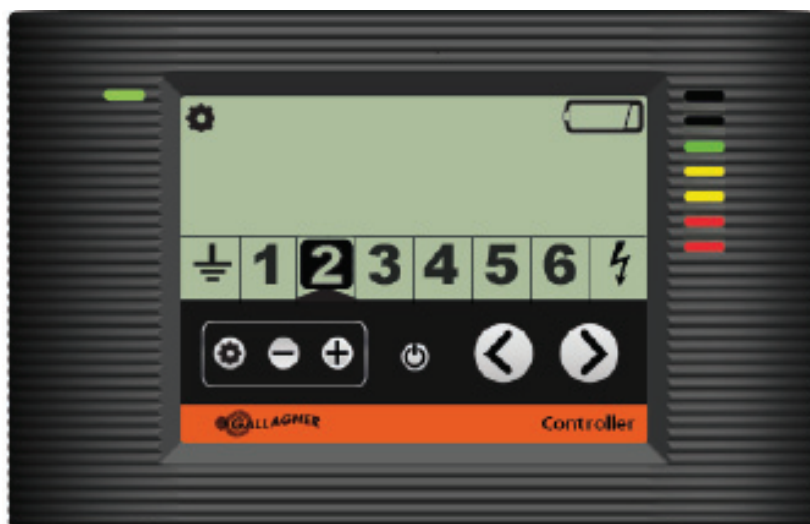
Controlador mostrando la zona 2 con batería baja
