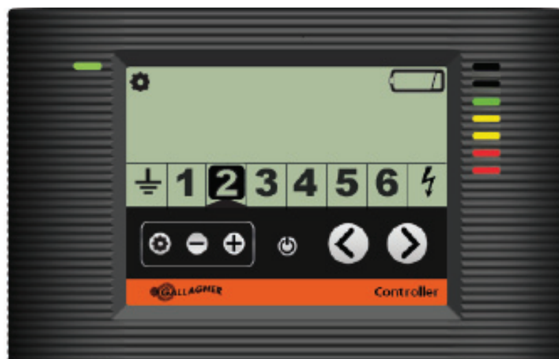
Contrôleur affichant la zone n° 2 avec une pile faible
