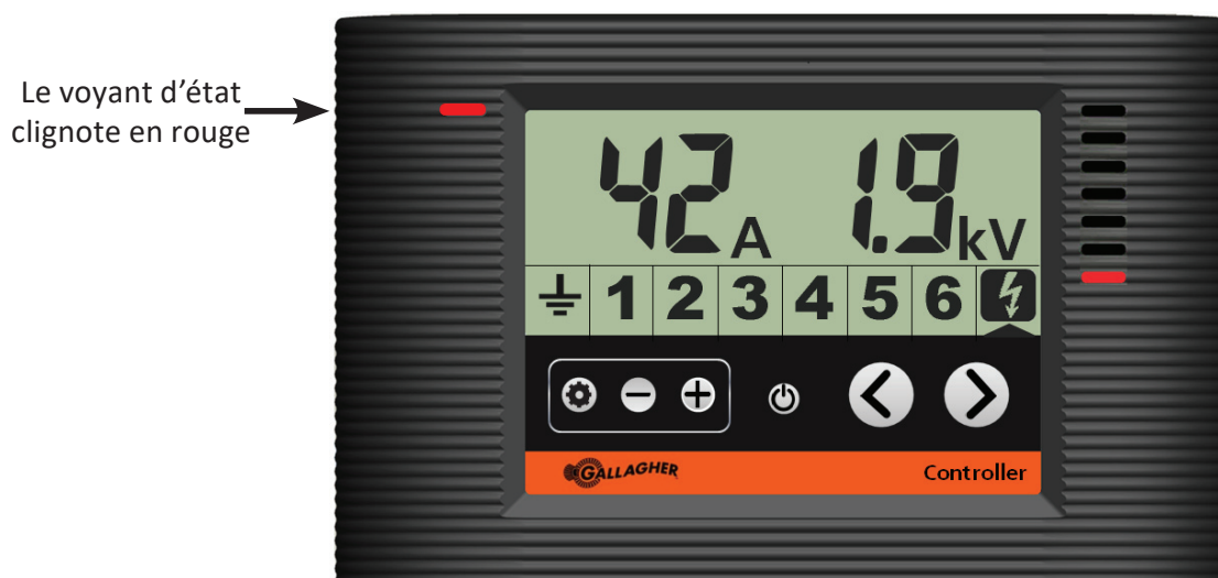
Contrôleur montrant l'électrificateur en état d'alarme
