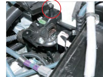
ステーの下に 30mm スペーサーを挟み、ビスCでボディに固定します。
