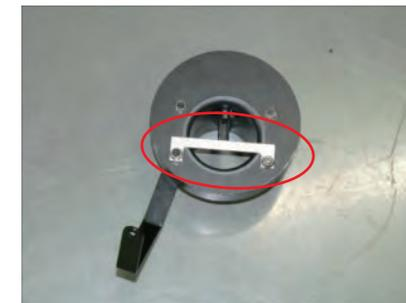
写真の様にアダプターにフィンを設置して、センサーアダプター、ステーを組み立てます。
