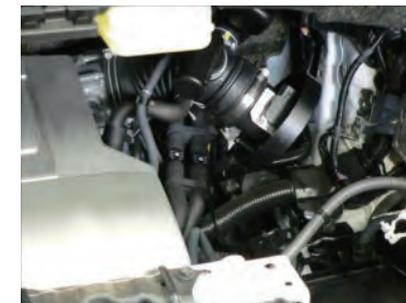
サクシジョンホースにセンサーアダプター ASSYを取り付けます。(径が小さく緩いです)ホースが緩いのでホースバンドを付属バンドに交換します。
