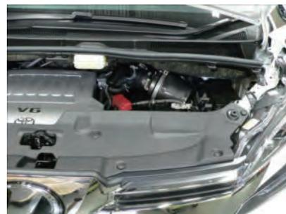
外したバッテリー・導入ダクト・パネルを取り付けます。
