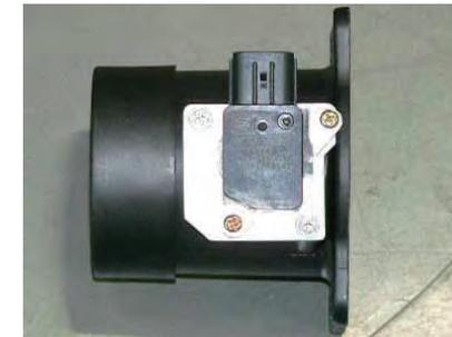
センサーアダプターにエアフロセンサーをスペーサーを挟みビスDで取り付けます。
