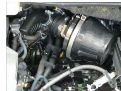
ECU・バッテリーとのクリアランスが少ない為、干渉する場合は、センサーアダプターを回転させてください。
