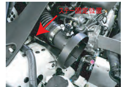
6.アダプターをサクシオンホースに差し込み、ステーでボディに固定します。配線類はタイラップ小で留めます。
