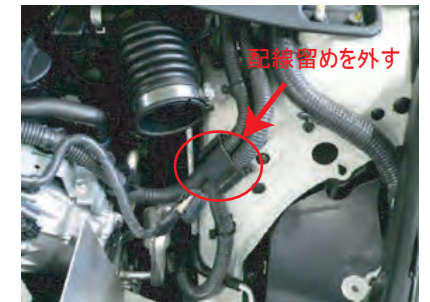
9.プラスチックの配線留めを外します。
