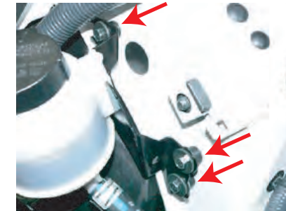
5.パワステオイルタンク固定ブラケットの下にスペーサー10mm、ワッシャーを挟みます。(3箇所)
