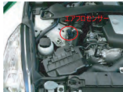
2.エアフロセンサーのカプラー及び、固定ボルトを外し、上に引き上げて外します。ノーマルケースからエアフロセンサーを取り外します。
