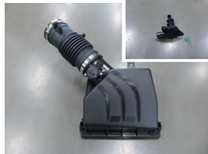
6. バンドを緩めてクリーナーボックスからサクシジョンホースを取外し、エアフロセンサーをクリーナーボックスから取外します。
