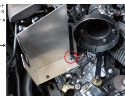
17. ヒートプレートにステアBをビスAx1とM6ナットx1で固定します。各ステアを増し締めをします。
