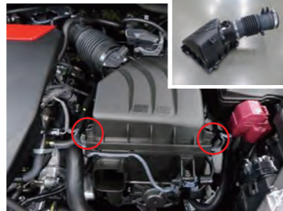
3. クリーナーボックスのロックを解除します。サクシジョンホースのバンドを緩めてクリーナーボックス上部とサクシジョンホースを取外します。
