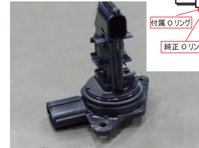
8. エアフロセンサーにOリングを元から付いているOリングの上に取付けます。
