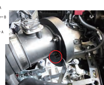
14. アダプターにステアBをビスBx1とM6ナットx1で仮留めします。
