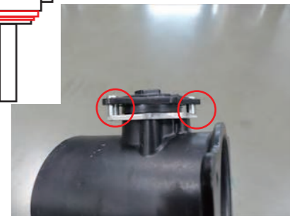
9. エアフロアダプターとセンサーの間にM4スペーサーx2を挟み、ビスEx2で取付けます。
