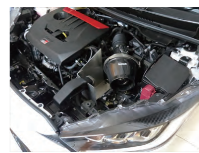
18. ロアケースにフィルター、カーボンケースをクランプで組み付けて取付けます。エアフロセンサーのカプラーを取付け、純正導入ダクトをヒートプレートに差し込んで純正クリップで固定します。アクチュエーターにカプラーを取付けて、タイラップでボディーに固定します。
