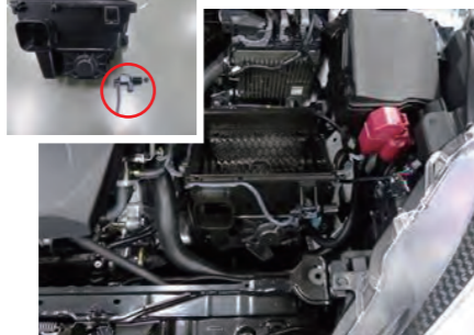
5. クリーナーボックス下部を取外し、アクチュエーターをクリーナーボックスから取外します。
