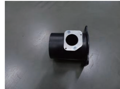
7. エアフロアダプターに変換プレートを皿ビスx2で取付けます。変換プレートの向きに注意して下さい。
