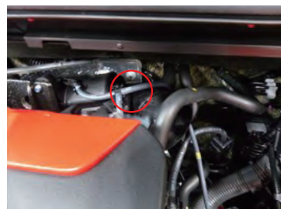
4. バキュームホースを取外します。外した箇所にごムキャップを取付けます。
