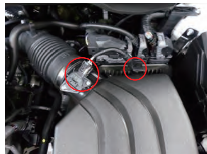
2. エアフロセンサーのカプラーを取外し、クリーナーボックスから配線留めを取外します。
