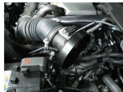
車両にセンサーアダプター ASSY を サクシジョンホースに取り付けます。
