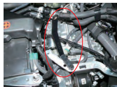
ステーの下に 20mm スペーサーを 挟み、ビス B で取り付けます。
