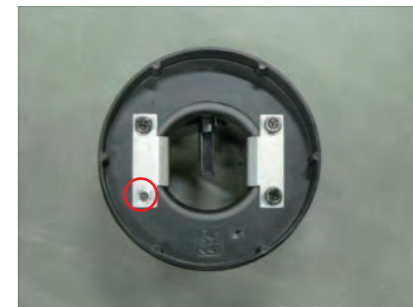
赤丸印の孔には後にステーが固定され るので現段階ではビスは取り付け ません。
