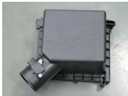
エアクリーナーボックス上部を外します。
