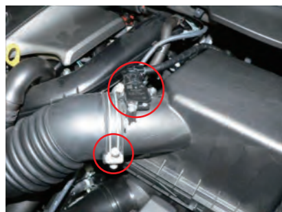
エアフロセンサーカプラーを外します。 サクシジョンホースバンドを緩めます。
