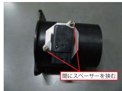
M4 スペーサーを挟み、エアフロセン サーをビスCで取り付けます。
