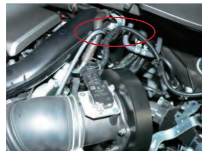
エアフロセンサーカプラーを取り付 けます。センサー配線をタイラップ で留めます。
