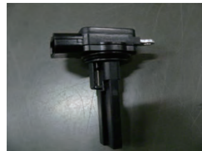
エアフロセンサーに付属のOリングを取り付けます。 (純正Oリングは外しません)
