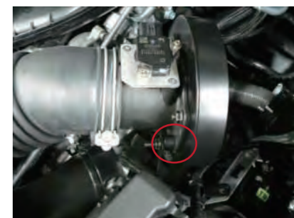
スペーサーを挟み、ビス B とナット でアダプターを固定します。
