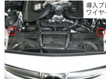
カーボン導入プレートを純正のボルトで2箇所取り付けます。
