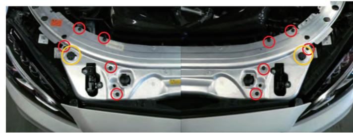
ボルトとボンネットラバーを外します。ボンネットラバーは外す前の高さ分かるように印を付けておいてください。
