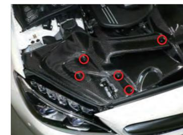
カーボンプレート(左右)を純正ボルトとビスAで固定します。(左右)
