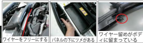
クリップを外し導入パネルを取り出します。
