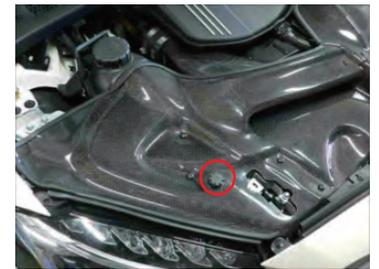
ボンネットラバーは、元の高さに調節して取り付けます。(左右)
