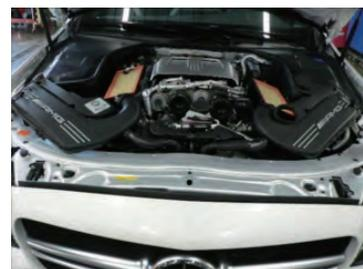
サクシオンホースバンドとボックス上部を固定しているビスを緩めます。ボックス上部をずらしします。
