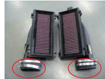
ボックス下部を取り出し、付属のK&N フィルターに交換します。ボックスに付属ラバーホースを取り付けます。付属バンドを使用。
