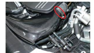
導入ダクトがパネルのミゾに収まる様に位置を調整し配置してバンドを緩めます。
