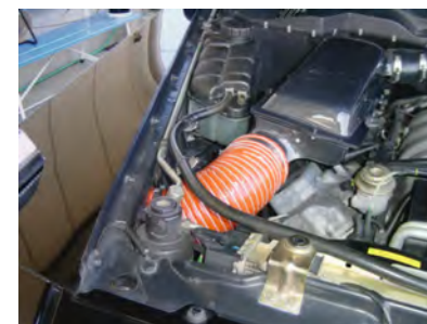
ノーマル導入口とフィルターケースのホースの上からエアードクト挿し込み、バンドで固定します。
