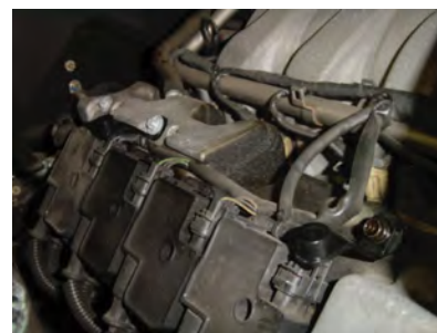
エンジンカムカバー部のボルトにステーを共締め固定します。(左右2箇所ずつ)
