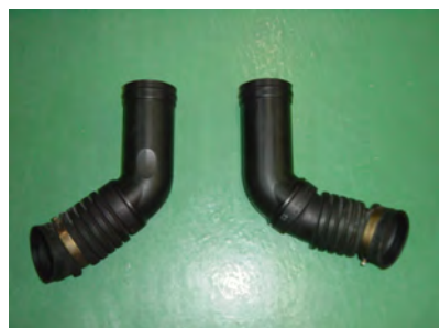
ノーマルの導入ダクトを外します。
