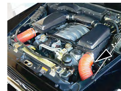
各部増し締め固定します。矢印部が干渉しますのでクッションテープを貼って保護してください。
