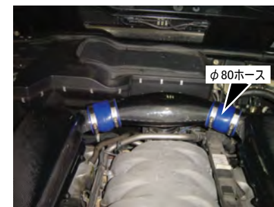
アップパーケースに三つ又パイプと接続します。アップパーケースをビスAで取り付けます。
