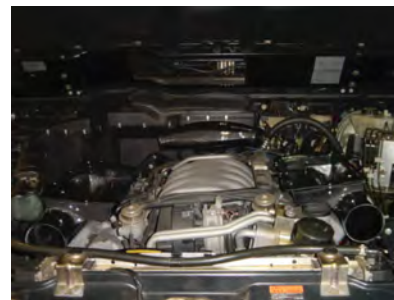
左右それぞれロアケースをステーの上のせて、ボルトで固定します。(右側はビスC、左側はビスBを使用)同時にエアフロメーターに付属の三つ又パイプを取り付けます。
