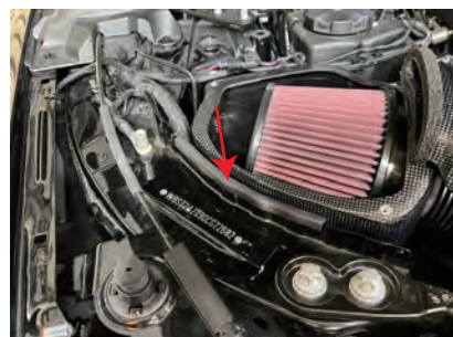
31. 付属の両面テープを溝ゴムの大きさにカットし、ボディに両面テープで溝ゴムを貼付けます。反対側も同様に貼り付けます。
