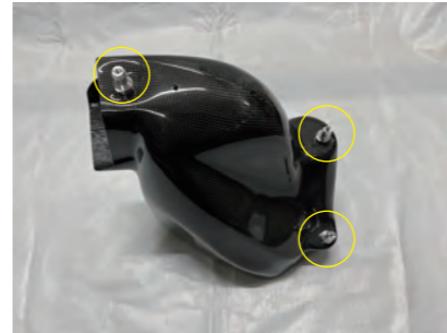
17. カーボンケース R にアルミスタッド x3 をボルト B x3 で固定します。
