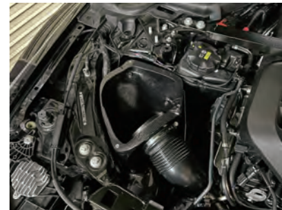
19. カーボンケースに付けたアルミスタッドをゴムプッシュに差し込み車両に取付けます。サクションパイプをアダプターに差し込みます。
