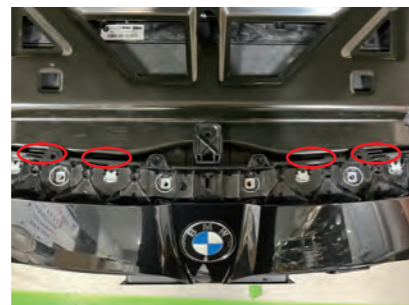
7. バンパーを少しめくりパネルを固定しているクリップを 4 箇所取外します。
