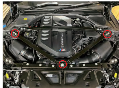
1. ボルト 1 箇所とナット 4 箇所を取外し、タワーを取外します。
