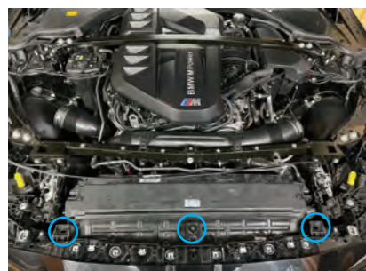
9. パネルを取外します。取外す際にバンパー取付部の 3 箇所を持ち上げすぎると破損に繋がりますので注意してください。
