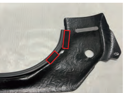
37. ウェザーストリップが外れないように付属のクッションテープをカットしてウェザーストリップとカーボンパネルを貼付けて留めます。反対側も同様に固定します。(右参考写真)
