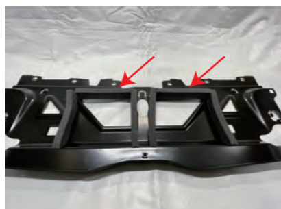
11. スリット入スポンジを両面テープのサイズにカットし、スリット面を貼付けます。角の部分は斜めにカットします。(12の写真参考)
