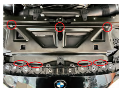
15. パネルを取付けます。バンパーとパネルを純正クリップで固定します。黄色箇所のボルトを仮止めします。ボンネットワイヤーをパネルに取付けます。
