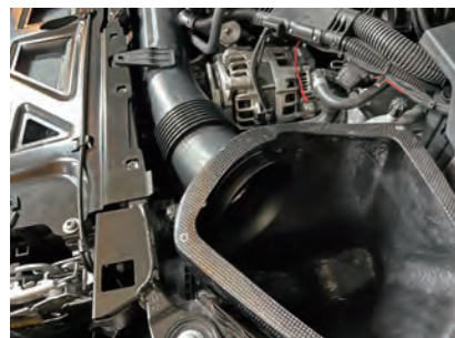
23. アダプター B をケースの内側から差し込み、サクシオンパイプに取付けます。
