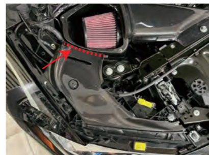
30. カーボンパネルを車両に仮で取付けます。カーボンパネルが干渉する箇所に溝ゴムを取付けます。(31を参照)
