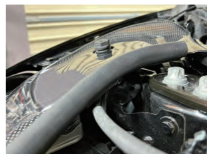
37. ウェザーストリップが外れないように付属のクッションテープをカットしてウェザーストリップとカーボンパネルを貼付けて留めます。反対側も同様に固定します。(右参考写真)
