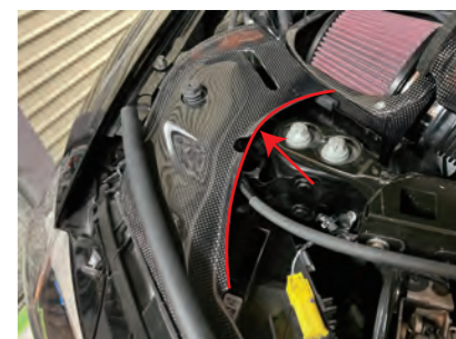
36. ウェザーストリップをカーボンパネルに取付けます。反対側も同様に取付けます。
