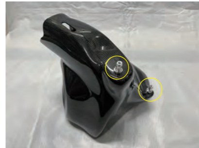
20. カーボンケース L にアルミスタッド x2 をボルト B x2 で固定します。
