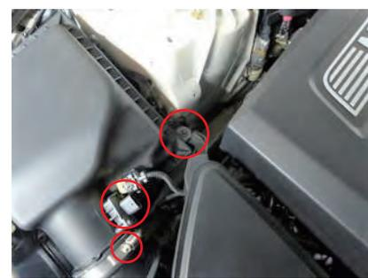
4. エアクリーナーボックスとレゾネーターを固定しているボルトを取外し、エアフロセンサーのコネクターを取外し、バンドを緩めます。
