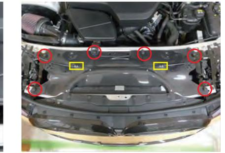
15. ゴム部とラジエーターの間に導入口を差し込み、純正ボルトで 6 カ所で導入パネルを固定し、ワイヤーをクランプに固定します。
