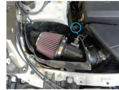
14. フィルターケースとレゾネーターを純正ビスで固定します。センサーのコネクターを取付けます。フィルターをエアフロアダプターに取付け、バンドを締め付けます。
