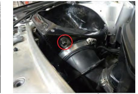
12. ステー B をホースとホースバンドの間に挟み込みフィルターケースにビス A で固定します。
