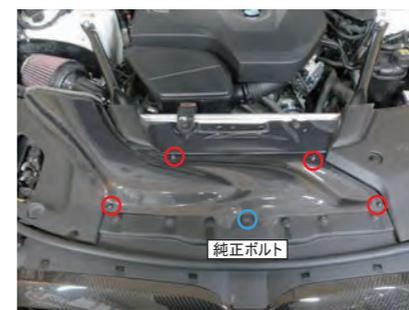
17. 導入ダクトをビス Dx4 と純正ボルトで固定します。
