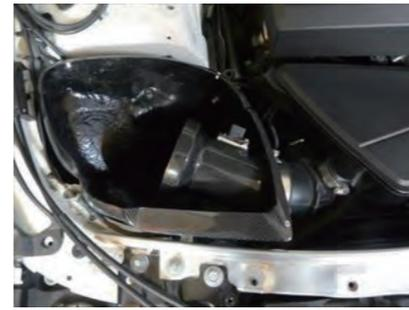
13. エアフロアダプターをフィルターケースの内側からホースに差し込み、バンドを締め付けます。(センサーがフィルターケースとケースカバーに干渉しない様に注意して下さい)
