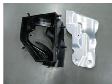
6. クリーナーボックス下部からヒートプレートを取り外します。
