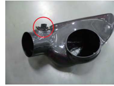
14. M4スペーサーをセンサーと台座の間に2個挟み、ビスD2本でセンサーを固定します。
