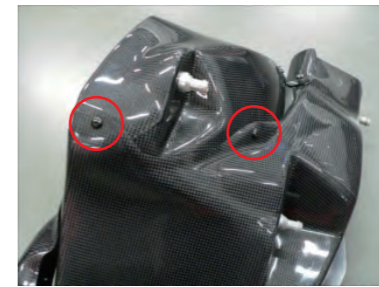
17. チャンバーケースとフィルターケースをビスEを2本使用して固定します。
