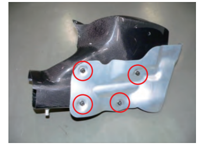
9. 15mmスペーサー4個を挟み、ビスC4本でヒートプレートをナット4個を使用して固定します。
