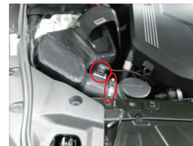
20. センサーカプラーを取り付けます。ホースバンドを締め込みます。
