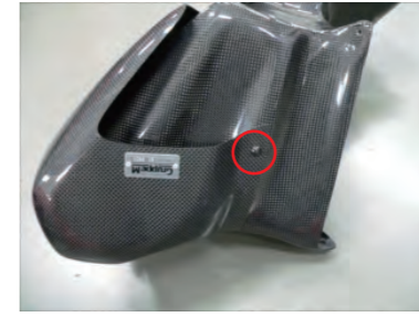
11. ビスE1本でカーボンヒートプレートを固定します。
