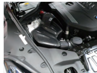
19. アルミスタッドがグロメットに刺さるように車両にカーボンASSYを配置します。
