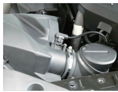
2. ホースバンドを緩め、センサーカプラーを外します。
