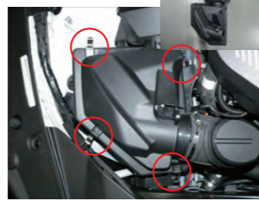
3. フックを4箇所外しクリーナーボックス上部を取り出します。
