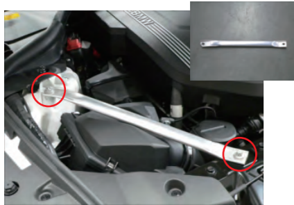
1. ボルトを2本外してタワーバーを外します。
