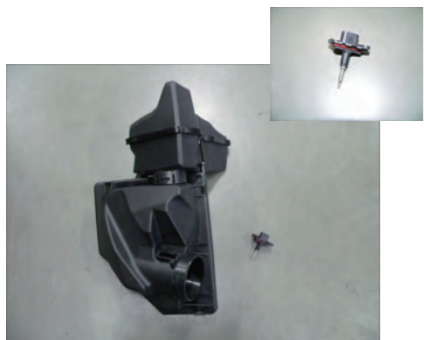
4. ボックス上部からセンサーを取り外します。
