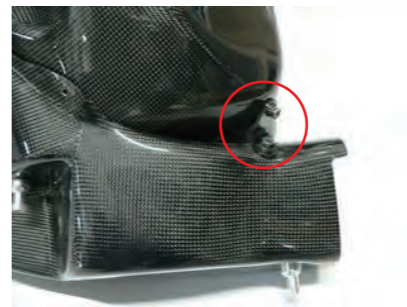
14. チャンバーケースとフィルターケースをビス A で固定します。8.12.13.14 の工程のビスを各部増し締めをします。
