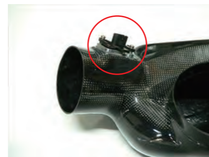
10. センサーと台座の間に M4 スペーサーを 2 個挟み、ビス C2 本でセンサーを固定します。
