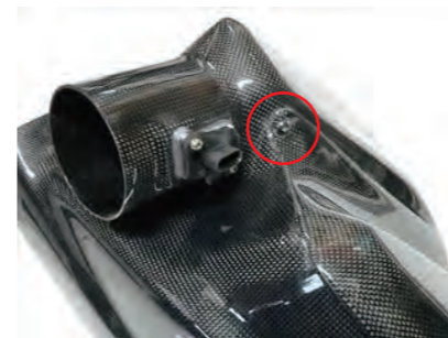
13. チャンバーケースとフィルターケースをビス E で固定します。
