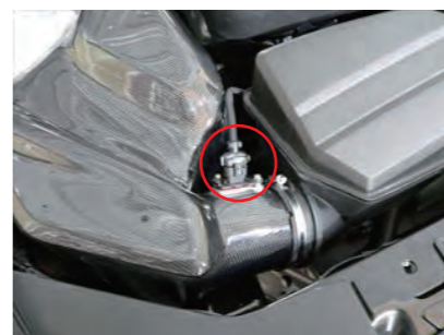
17. センサーカバーを取り付け、ロックをします。
