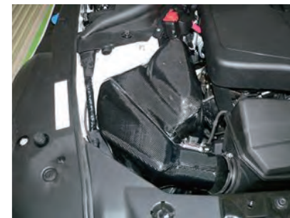
15. カーボン ASSY のアルミスタッドがグロメットにしっかりと 3 箇所刺さるように配置します。
