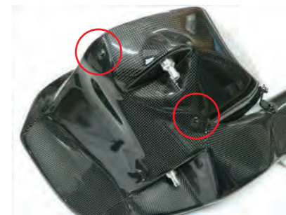
12. チャンバーケースとフィルターケースをビス E を 2 本使用して固定します。
