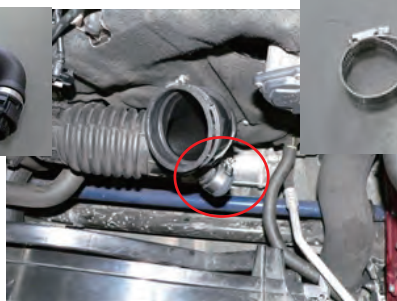
エアホースを取り外した所に、付属のラバーキャップをかぶせてバンドで留めます。
