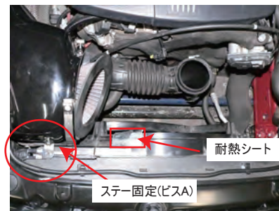
付属タッピングビスで取付け
