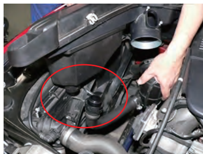
エアマスセンサーのカプラーを外して、サクシオンホースのバンドを緩めます。ケース下側のエアホースを外します。
