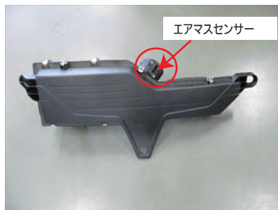
エアクリーナーケースからエアマスセンサーを取り外します。
