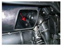
フィルターケースの内側孔からラバー付スタットボルト を出してワッシャー、ナットで固定します。 同時にエルボウホースをエアマスセンサーに取り 付けます。
