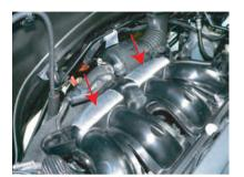
インマニの上にフィルターケースを乗せて配置する ため、インマニ部に耐熱テープ(小)を貼り付けます。 その孔にラバー付きスタッドボルトを取り付けます。 (写真参照)
