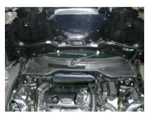
ノーマルクリーナーケースを取り外します。 エアマスセンサーごとケース上側、ケース下側の エアパイプを外し、ケース下側を外します。
