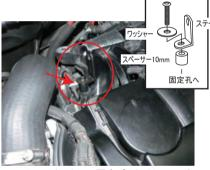
ノーマルフィルターケース固定ボルト孔にステーを 取り付けます。ステーの下にスペーサーを挟み、 ノーマルボルトで固定します。ノーマルボルトと ステーの間にワッシャーを挟みます。
