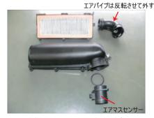
ケース上側のエアマスセンサーを外します。 エアマスセンサーはインテークホースに取り付けます。
