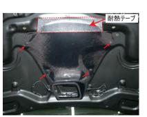
導入ダクトを付属のダクト用クリップで取り付けます。 耐熱テープを点線部にカーボン導入ダクトの上から とボンネット裏に一緒に貼り付けます。
