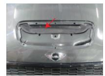
ボンネットの導入部にカーボン導入プレートを貼り 付けます。元の通りノーマルダクトを取り付けます。
