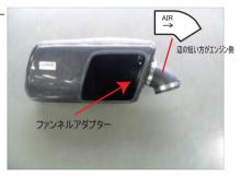
ファンネルアダプターをケース内側から入れて ビスAで取り付けます。 アダプターにエルボウホースを取り付けます。 ホースの向きは、辺の短い方がエンジン側に なるように組み付けます
