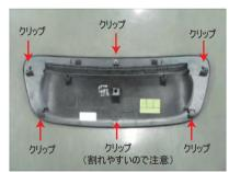
ボンネットとダクトのすきまにトリムパットツールなどを 差し込み、真上に押し上げて、6箇所のクリップを外
