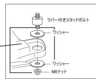
イラストのようにワッシャーを孔の上下に挟んで ラバー付きスタッドボルトをナットで固定します。
