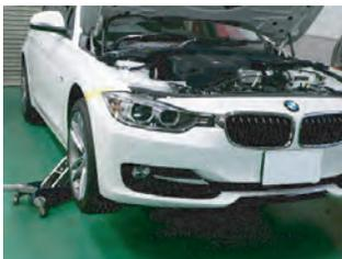
エア導入プレートを取り付ける為、フロントバンパーを外します。ジャッキアップします。
