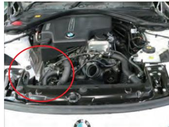
フェンダー内に補助ラジエター装備車は、ラジエターホースのレイアウトが違う為カーボンケース下側をカット加工してください。
