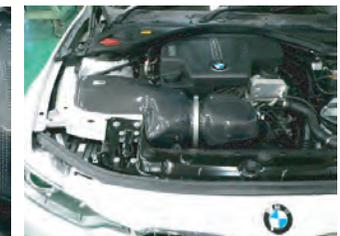
エアマスセンサーのカプラーを接続し、各部増し締め固定します。
