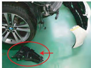
バンパー固定ビス、クリップを全て外します。(上面、下面、インナーフェンダー部) 矢印のカバーも外します。
