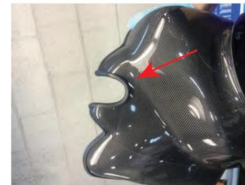
カットした断面に付属の溝ゴムを接着剤で貼り付けて、仕上げてください。
