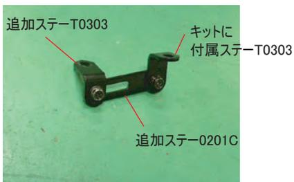
元々キットに付属されているステーT0303と追加ステーT0303と0201Cを組み付けます。(ビスAx2、ナットx2 使用)
