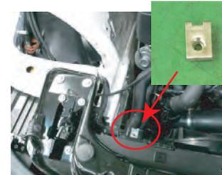
矢印部に付属のクリップナットを取り付けます。 ※Mスポーツは、別紙の補足説明参照
