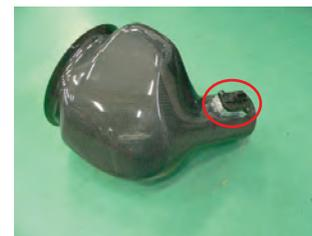
チャンバーケースにエアマスセンサーを取り付けます。(付属タッピング使用) ロックタイト塗布を推奨します。
