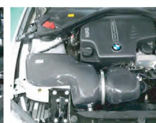
クリーナーASSYを配置して、サクシオンホースとカーボンパイプを接続して、バンドで締めます。
