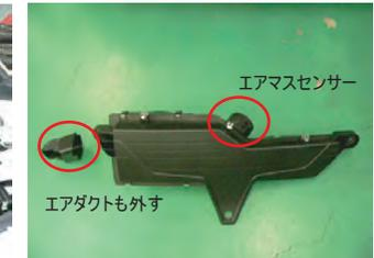
ノーマルのエアダクトも外します。クリーナーケースからエアマスセンサーを外します。
