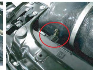
クリップナットを取り付けた所にスターT0303でフィルターケースを固定します。(ビスAx2個使用) ※Mスポーツは、別紙の補足説明参照
