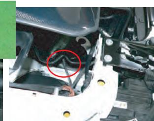
フィルターケース下側の凹みに合わせて配線ホースを通して、配置します。
