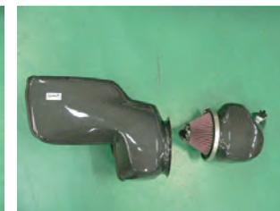
チャンバーケース、フィルター及びケースをVクランプで組み付けます。
