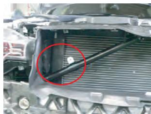
写真のように固定ブラケットをパイプ裏に挟んで、配置します。
