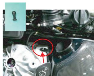
矢印部の樹脂ナットクリップを外して、そのスタッドボルト部にステーを入れて配置します。(樹脂ナットクリップでステーを固定します)
