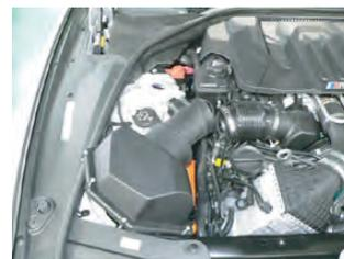
エアマセンサーのカプラーを外し、クリーナーケース上側を外します。(写真は右側)
