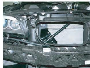
エア導入ダクトの固定プレートをパイプの裏に配置します。(写真は右側)
