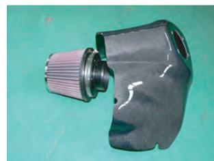
ファンネルアダプターにフィルターを取り付け、フィルターケースにビスAで取り付けます。(写真は右側)
