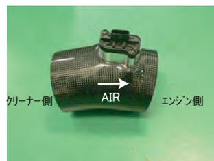
ノーマルクリーナーケースからエアマセンサーを外して、カーボンパイプに取り付けます。(付属タッピング使用)
