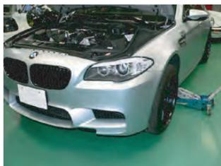
エア導入ダクトを取り付ける為、フロントバンパーを外します。ジャッキアップします。
