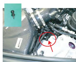
左側も同様に組み立てます。ステー固定はノーマルのクリップボルトを使用します。
