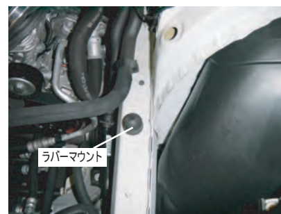
1: ノーマルケースを固定しているラバーマウントは取り外します。
