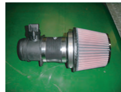
2: エアフロメーターにラバーホース、アダプター、フィルターを取り付け、バンドで締めます。
