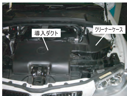
1: ノーマルの導入ダクトを外します。
