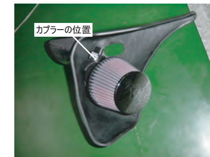
3: エアフロメーターのカプラーの位置を写真のように上部に向け、フィルターケースの丸穴に組み付けたエアフロメーターを差し込み、ノーマルのサクシジョンホースと接続します。
