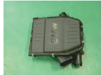
ノーマル導入とケースを外します。(下側のラバマウント3箇所固定されています)
