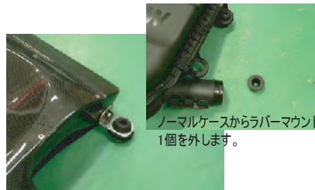
アルミステーにラバマウントを取り付け、ケースに固定します。(ビスB使用)
