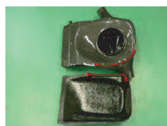
中間導入ダクトが乗る部分にパッキンテープを貼ります。ケースとカバーにパッキンテープをカットして貼り付けます。
