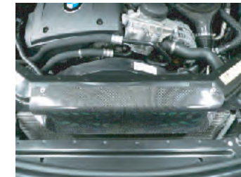
エアガイドをテープで仮留めします。
