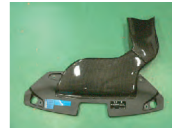
ノーマル導入にドリルでφ2.5の孔を開けます。付属M4タッピングで固定。 ※締めすぎるとカーボン樹脂が割れるので要注意。
