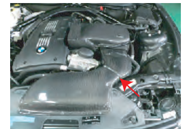
全体的にボンネットとのクリアランスは無く、エンジンの振動でボンネット裏の吸音材と干渉します。クリア樹脂表面が白くなった場合はコンパウンドなどで磨いて下さい。
