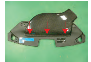
ノーマル導入にカーボンの導入ダクトカバーを被せて、前部3箇所の孔位置に印を付けます。
