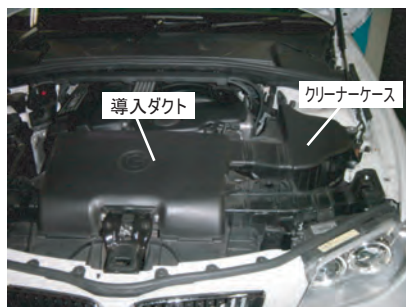
1: ノーマルの導入ダクトを外します。
