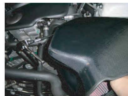
4: フィルターを手で押さえながら、エアフロメーターをサクシジョンホースに奥まで入れてバンドで固定します。 ※振動などで外れないように、しっかりとバンドを締めてください。
