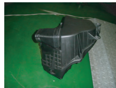
5: クリーナーケースの固定ボルトを外し、ケースASSYを取り外します。
