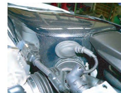
6: エアフロメーターのカプラーを取り付け、ゴムカバーを取り付けます。
