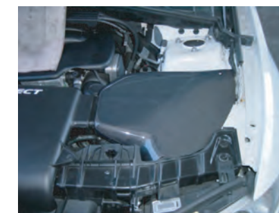
9: 各部増し締めし、干渉箇所がないかクリアランスなどを確認してください。定期的な増し締め点検を必ず行ってください。
