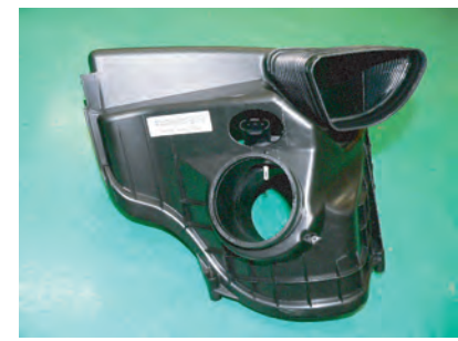
6: クリーナーケースの中を開け、エアフロメーターを取り外します。
