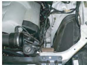
1: エアマスセンサーのカバーを外します。ボルト2箇所を外し、ノーマルクリーナーケースを取り外します。
