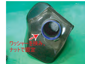
12: アダプターにフィルターを取り付けて、フィルターケース内に入れます。ラバーホース、スタッドボルトを孔から出してワッシャーを挟み、ナットで固定します。
