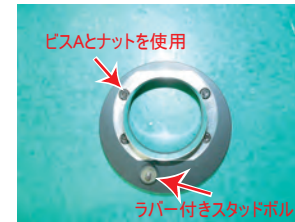
11: アダプターにジョイントアダプターを取り付けます。ラバー付きスタッドボルトを取り付けます。予めラバーホースも取り付けおきます。
