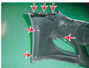
6: クリップ3箇所、トルクスボルト1箇所を外します。
