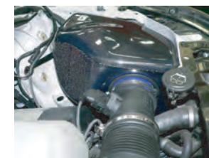
16: エアマスセンサーをノーマルインテークホースに取り付けます。
