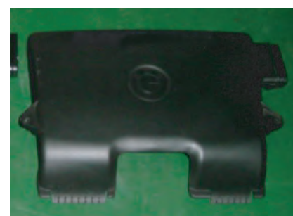
3: ノーマル導入ダクトを取り外します。
