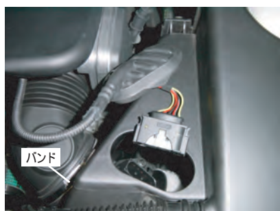
4: クリーナーケースのゴムカバーを外しエアフロメーターのカプラーを外します。同時にサクシジョンホースのバンドを緩めます。
