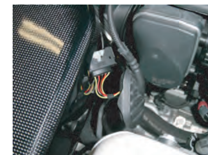
6: エアフロメーターのカプラーを取り付け、ゴムカバーを取り付けます。
