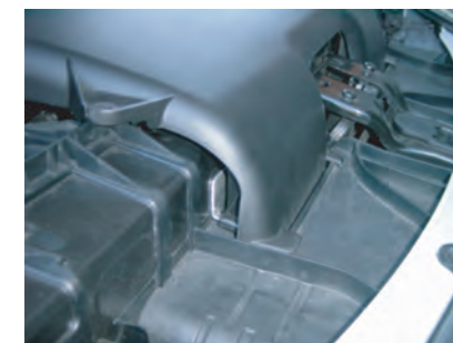
8: ノーマル導入ダクトを取り付けます。
