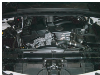
2: 導入ダクトはボルトで固定されています。
