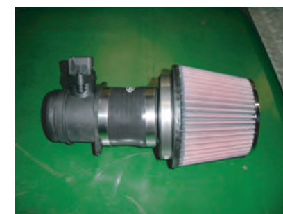
2: エアフロメーターにラバーホース、アダプター、フィルターを取り付け、バンドで締めます。
