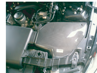
9: 各部増し締めし、干渉箇所がないかクリアランスなどを確認してください。定期的な増し締め点検を必ず行ってください。
