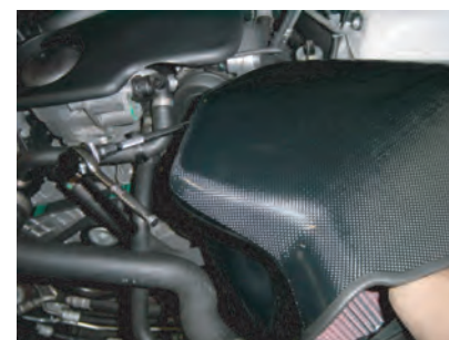
4: フィルターを手で押さえながら、エアフロメーターをサクシジョンホースに奥まで入れてバンドで固定します。 ※振動などで外れないように、しっかりとバンドを締めてください。
