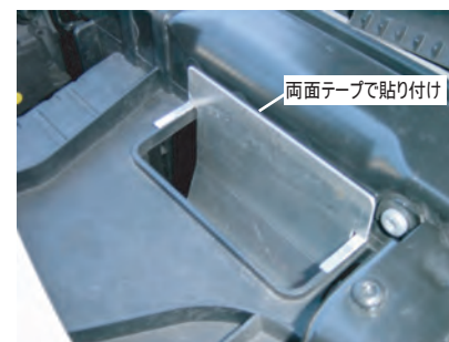
7: 付属のアルミ導入プレートの両面テープを剥がし導入口に貼り付けます。
