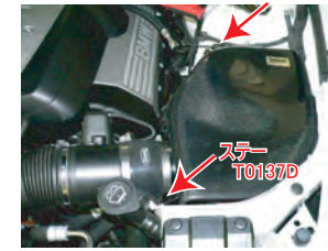
エアフロアダプターにホースを差し込みながらエンジンルームに配置します。
