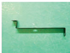
導入ダクトのセンター部固定用のステア(T0311B)
