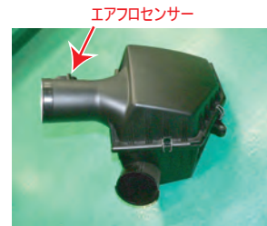
外したエアクリナーケースからエアフロセンサーを取り外します。
