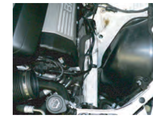
エアフロセンサーのカバーを外し、エアクリナーASSYを取り外します。
