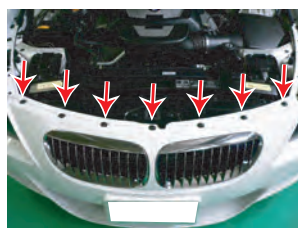
バンパーを取り外します。上部7箇所のボルトを外します。
