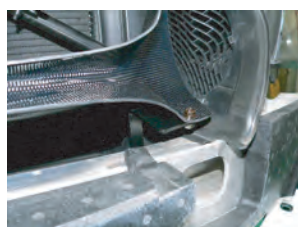
バンパー上部に配置して、ステアをバンパー裏に固定します。
