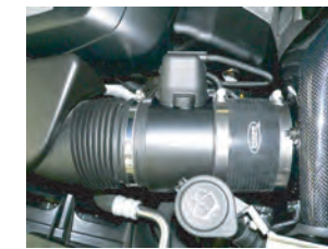
エアフロセンサーのカバーを取り付け、カバーカバーを元の通りに取り付けます。
