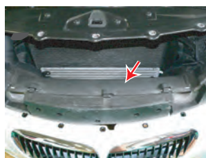
矢印部の樹脂カバーを取り外します。
