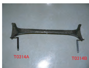
導入ダクトにステア(T0314A、T0314B)を取り付けます。(ピスA、ナットを使用)
