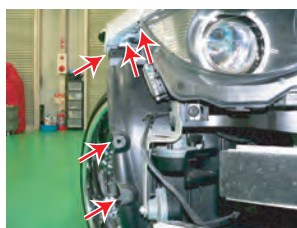
フェンダー部のボルト類を外し、バンパーを取り外します。
