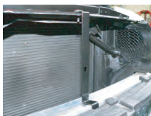
ステア上側はバンパーと共締めします。下側はバンパーフレームと発泡スチロールの間に挟みます。
