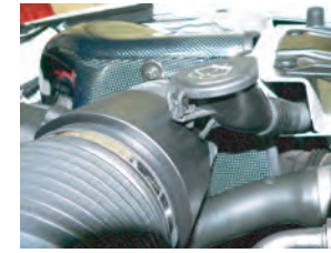
エアフロアダプターとウォッシャータンクホースと当たりに付属のクッションテープを貼り付けます。
