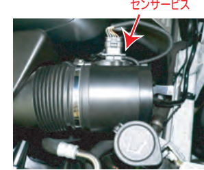
外したエアフロセンサーを付属のエアフロアダプターに取り付けます。それをノーマルインテークホースに差し込み、バンドで固定します。センサーの取り付け角度は写真の通りに傾けます。
